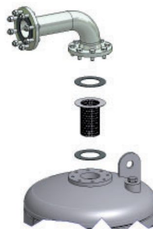
Démontage de la crépine
