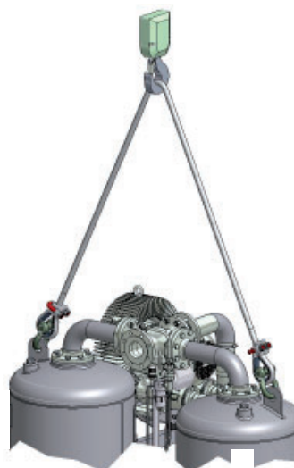
Transport avec une grue
